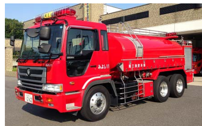
みよし11号車 小型動力ポンプ付水槽車(平成15年12月配備)
