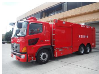
長久手11号車 小型動力ポンプ付水槽車
