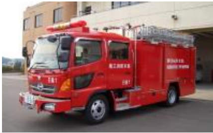
日進1号車 水槽付消防ポンプ自動車(救助対応)
