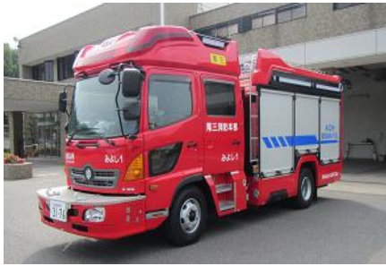
みよし1号車 水槽付消防ポンプ自動車(救助対応)
