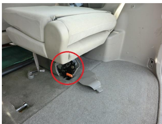
運転席側3列目シート ※座席固定部のカバー破損あり
