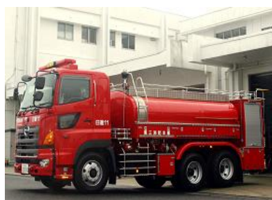
日進11号車 小型動力ポンプ付水槽車
