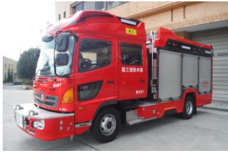
長久手1号車 水槽付消防ポンプ自動車 (救助対応)
