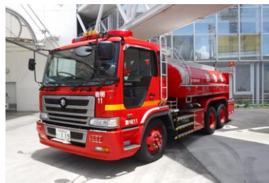
豊明11号車 小型動力ポンプ付水槽車
