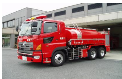
東郷11号車 小型動力ポンプ付水槽車
