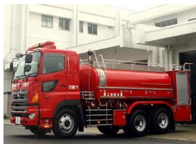
日進11号車 小型動力ポンプ付水タンク車
