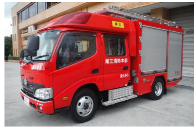
長久手2号車 消防ポンプ自動車
