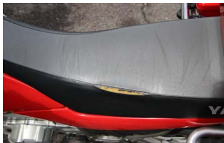
シートの破れ
