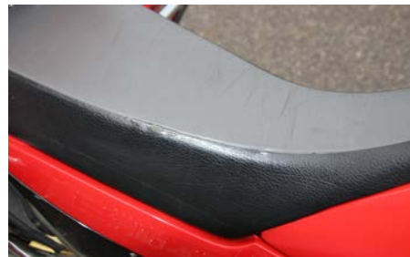
シートの破れ
