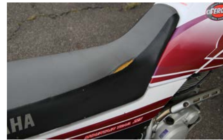
シートの破れ
