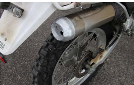
マフラーの補修
