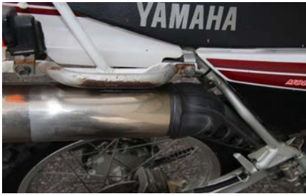
タンデムの錆
