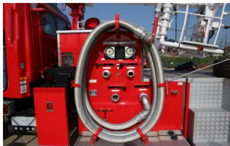
左面ポンプ回り
