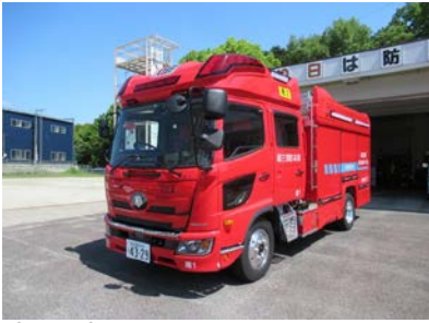
南1号車 水槽付消防ポンプ自動車
