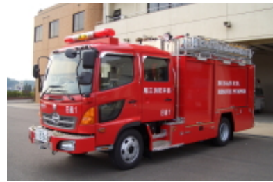
日進2号車 水槽付消防ポンプ自動車(救助対応)
