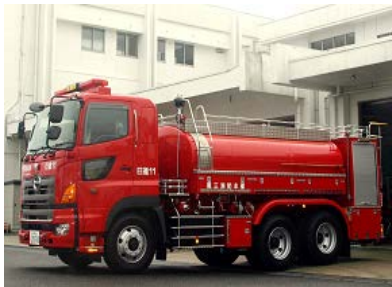
日進11号車 小型動力ポンプ付水槽車
