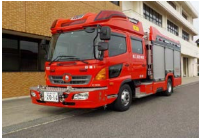
日進1号車 水槽付消防ポンプ自動車(救助対応)
