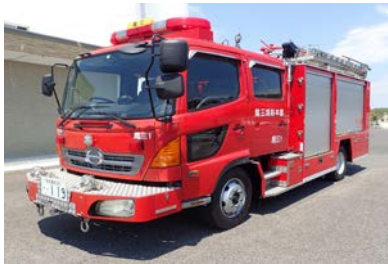
尾三1号車 水槽付消防ポンプ自動車
