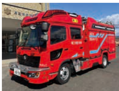
水槽付き消防ポンプ車
