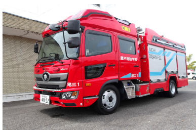
尾三1号車 水槽付消防ポンプ自動車
